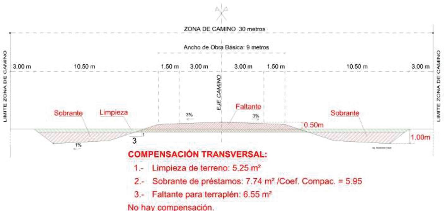
Esquema N° 5 - Ejemplo de compensación transversal
