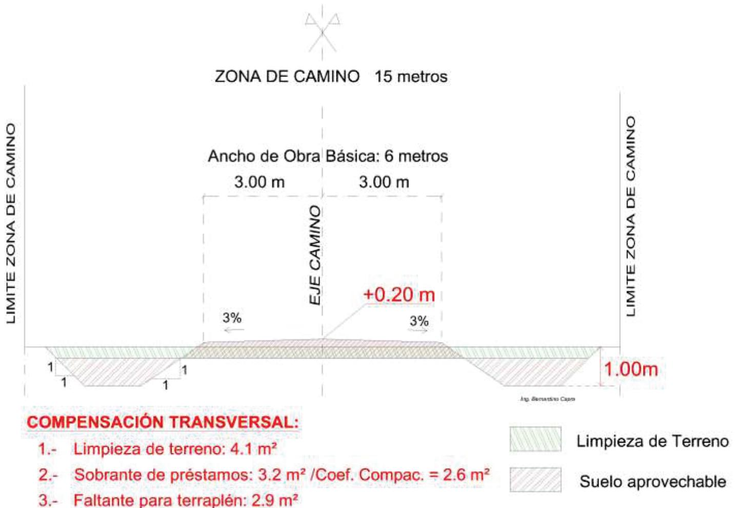
Esquema Nº 6 - Ejemplo de compensación transversal AZC de 15 m.
