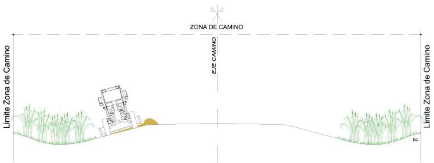
Esquema N° 8 - Reconformado de la Obra Básica
